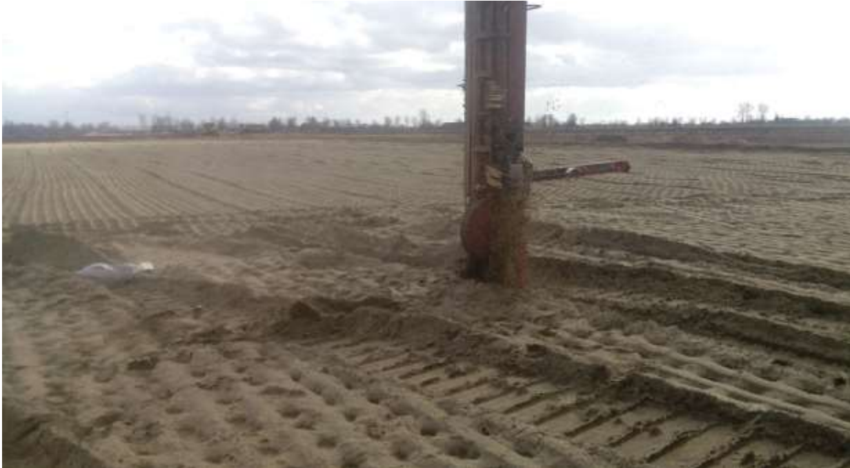
Rys. 23 Przedmuchy przez przewarstwienia piasków
