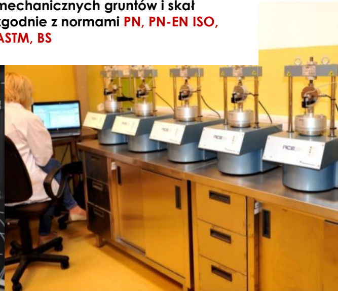
ZESTAW AUTOMATYCZNYCH EDOMETRÓW DO BADANIA WŁAŚCIWOŚCI ODKSZTAŁCENIOWYCH
