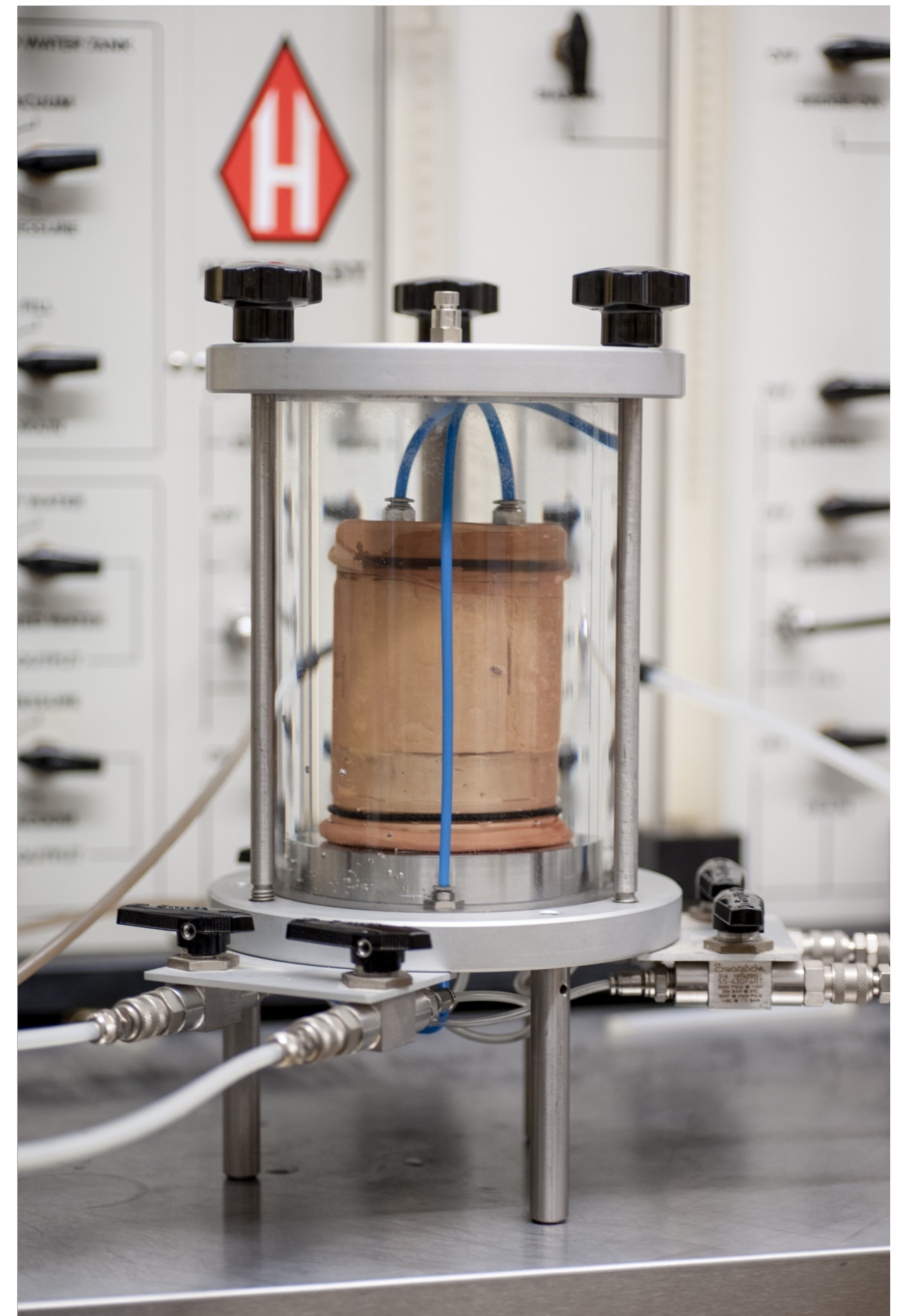
Fig. 2 Komora do badań wodoprzepuszczalności (fot. Marta Szlaza).
