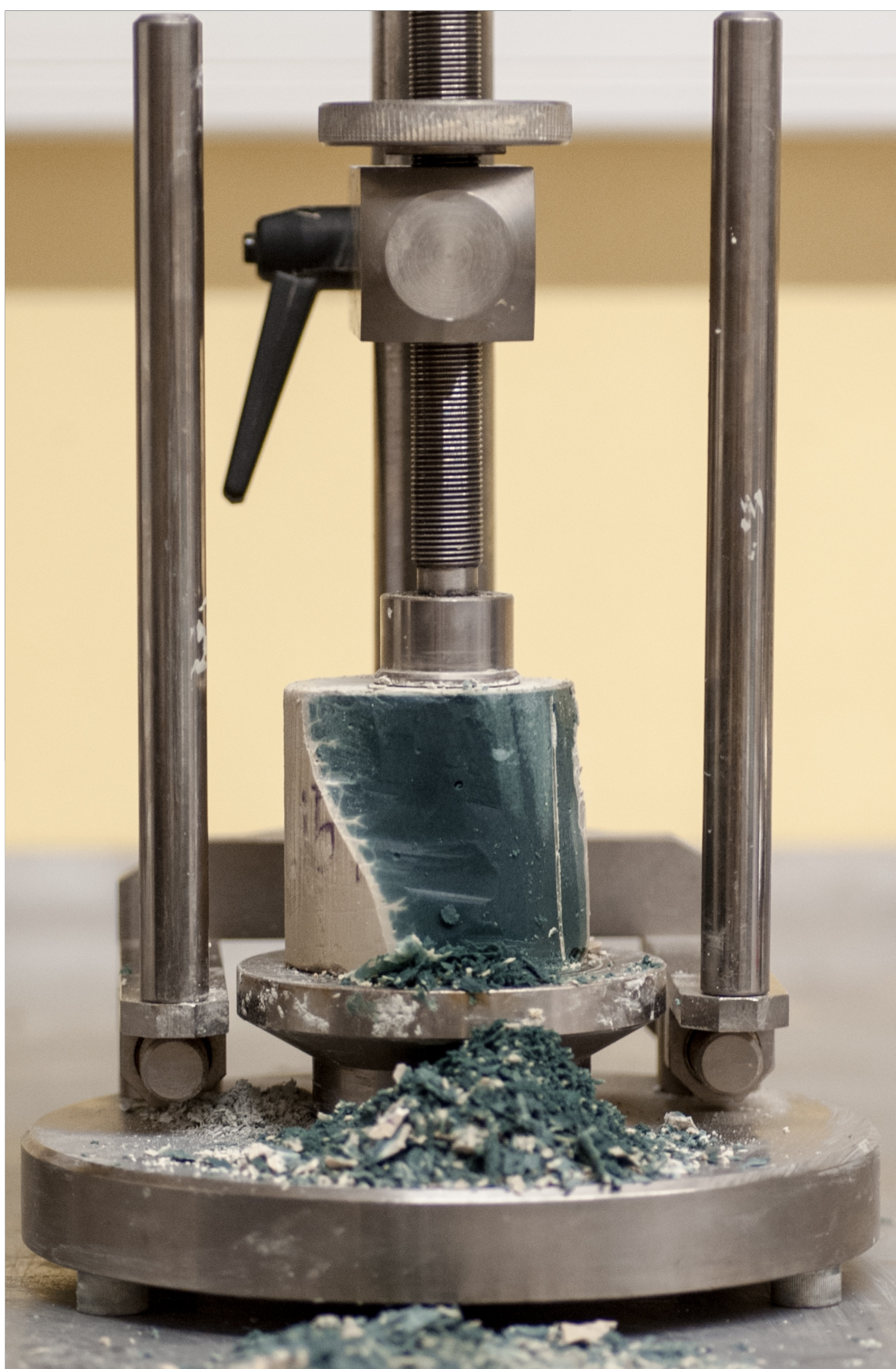
Fig. 3 Próbkę gruncocementu przeznaczona do badań wodoprzepuszczalności (fot. Marta Szlaza)
