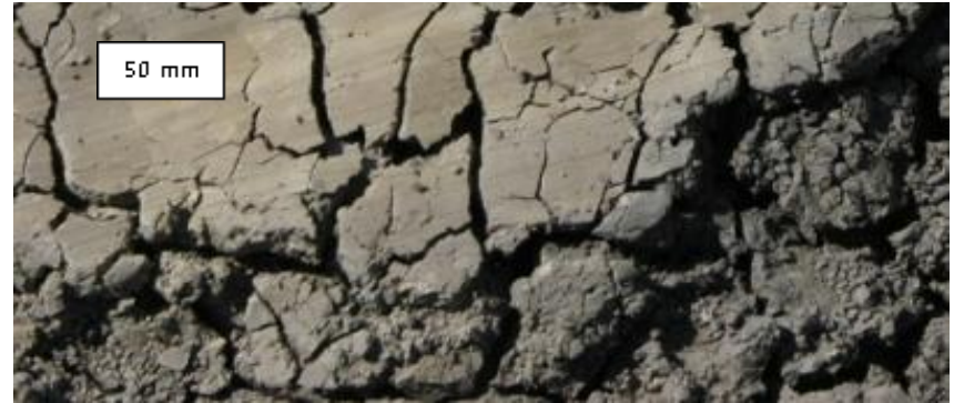
Szczeliny skurczowe i dezintegracja granularna łu w wyniku suszenia, po 24 godzinach.
