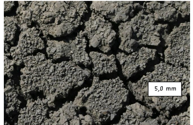
Szczeliny skurczowe i dezintegracja granularna łu w wyniku suszenia, po 24 godzinach.
