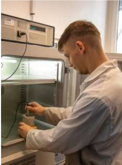
Pomiar właściwości termicznych gruntu laboratoryjnym miernikiem TK04
