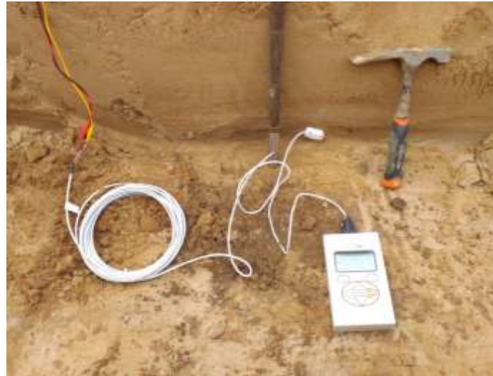
Pomiar właściwości termicznych gruntu w terenie
