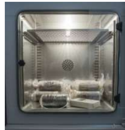
Pomiar urządzeniem KD Pro w inkubatorze termicznym
